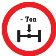
ပုံ ၉၈ ဝင်ရိုးပေါ်သက်ရောက်အလေးချိန် ( ) တန်ကျော်ယာဉ်မဝင်ရ
